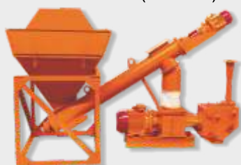
Установка для выгрузки цемента из хопров В-283-031 (30 т/ч)
