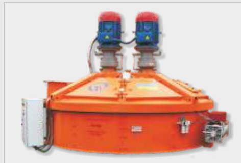
Бетоносмеситель планетарно-роторный СБ-242-8М, емкостью 1,0м 3 ;
